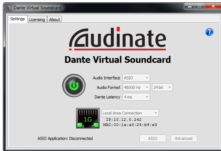
図 2: アクティブネットワークリンクで駆動するDante Virtual Soundcard
