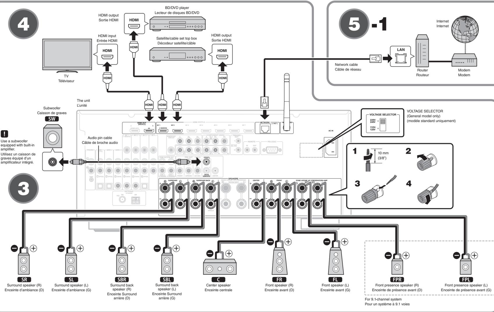
Use a subwoofer equipped with built-in amplifier. Utilisez un caisson de graves équipé d'un amplificateur intégré.
